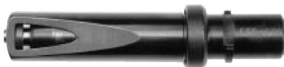
Las boquillas disponibles de la serie H513 pueden acomodar lockbolts de diámetro 1/8 pulg. a 1/4 pulg. en longitudes variables. La boquilla de la figura tiene una boca cincelada, de retorno, con punta giratoria de 3,5 pulgadas de longitud desde la línea de la pistola.
