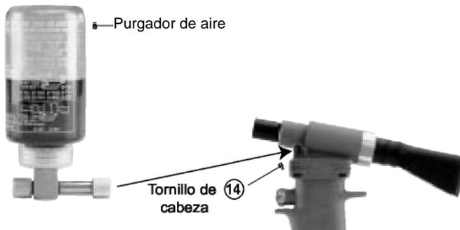
1. Separe el conjunto del cabezal (1) del cuerpo (31) desenroscando los tornillos de cabeza (53).
