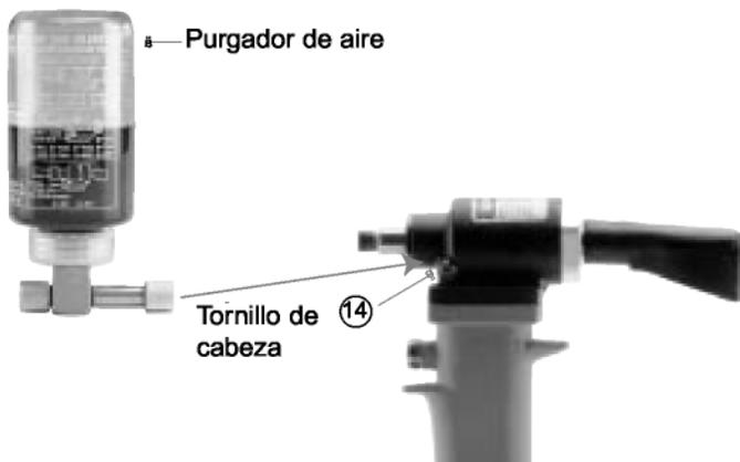
1. Después de retirar el conjunto del cabezal, llene el conjunto del cuerpo (31) con el aceite recomendado hasta llegar aproximadamente a 1/8 pulg. (3,175mm) de la parte superior del cuerpo.
